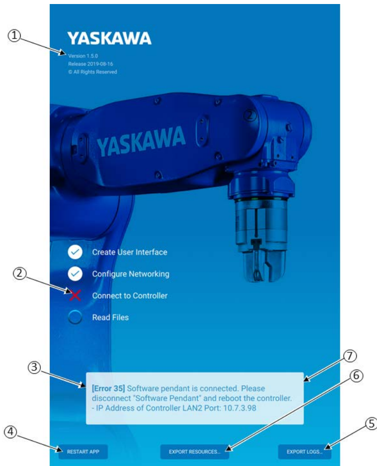
Fig. 15-1: Startup Error Layout
